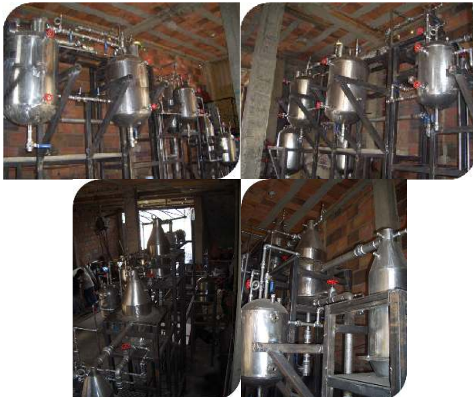
Figura 5. Prototipo del evaporador de múltiple efecto ensamblado.
