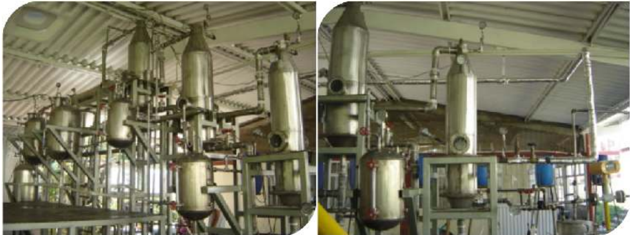
Figura 8. Prototipo del evaporador de múltiple efecto modificado.
