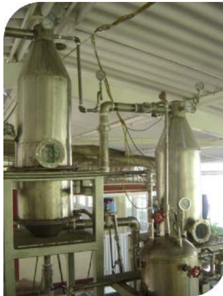
Figura 9. Detalle de un efecto del prototipo del evaporador de múltiple efecto instalado en el CIMPA.
